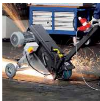
GRIT GIMS Мобильная каретка для базового модуля
